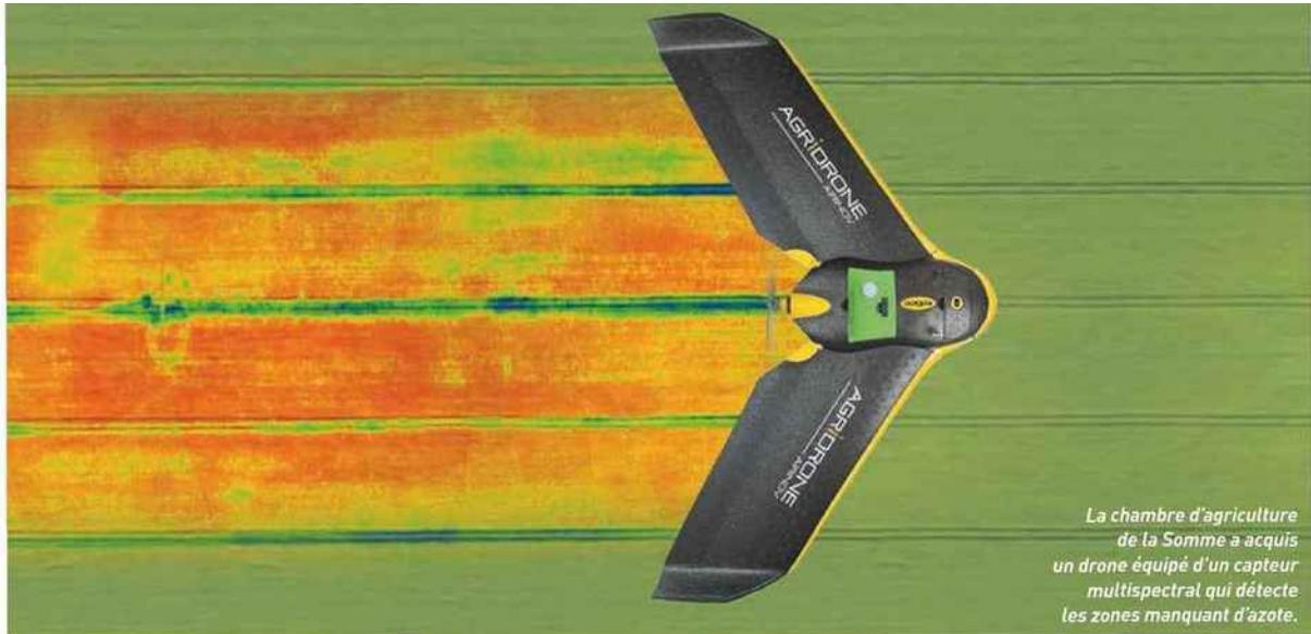
La chambre d'agriculture de la Somme a acquis un drone équipé d'un capteur multispectral qui détecte les zones manquant d'azote.
